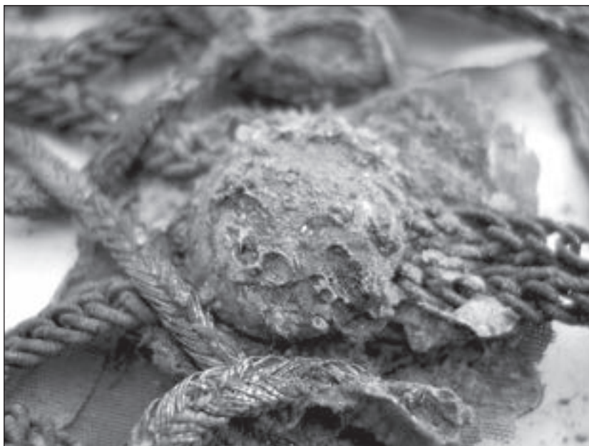
Nasture-înainte de curățire- se observă produșii de coroziune specifici cuprului
